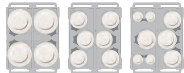
4x ø225-330 mm/MM 6x ø140-225 mm/MM 4x ø115 mm/MM 2x ø140-175 mm/MM 2x ø175-225 mm/MM
